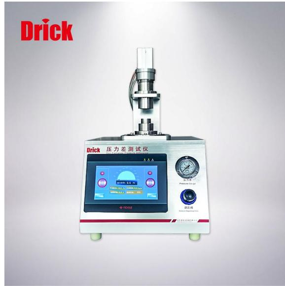
DRK-206 口罩压力差测试仪根据相关标准生产，主要用于口罩、呼吸器在规定条件下的压力差测试。适用于口罩及呼吸器生产企业、质量监督、科学研究、佩戴使用等单位。
