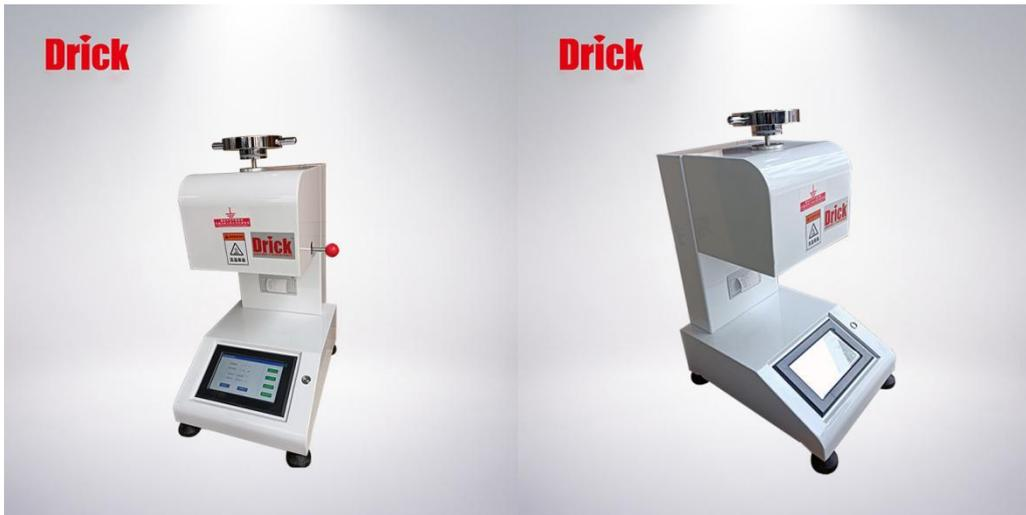
DRK208 熔体流动速率测定仪是按 GB3682-2018 的试验方法测定塑性高聚物在高温下流动性能的仪器，用于聚乙烯、聚丙烯、聚甲醛、ABS 树脂、聚碳酸酯、尼龙氟塑料等高聚物在高温下熔体流动速率的测定。适用于工厂企业及科研单位的生产和研究之中。
