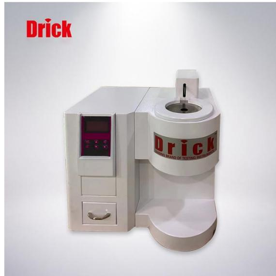
XRL—400B 系列熔体流动速率仪是用来表征热塑性高聚物在粘流状态时流动性能的仪器，用来测定热塑性树脂的熔体质量流动速率（MFR）和熔体体积流动速率（MVR），熔体流动速率仪既适用于熔融温度较高的聚碳酸酯、尼龙、氟塑料、聚芳砜等工程塑料，也适用于聚乙烯、聚苯乙烯、聚丙烯、ABS 树脂、聚甲醛树脂等熔融温度较低的塑料测试，广泛地应用于塑料原料、塑料生产、塑料制品、石油化工等行业和相关的大专院校、科研单位、商检部门。
