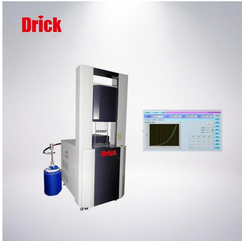
DRK-PFI11TR 低温回缩利用压缩机机械制冷提供恒定的低温环境，并可根据设定的升温速率升温。冷却介质为酒精（客户自备），通过机台的专用拉伸治具和位移传感器测量橡胶等材料在低温冷冻一段时间后随着温度的逐渐升高变形量到达规定值时的温度值。本机采用电脑系统集成化控制，软件一键化测试，自动计算等相关参数。
